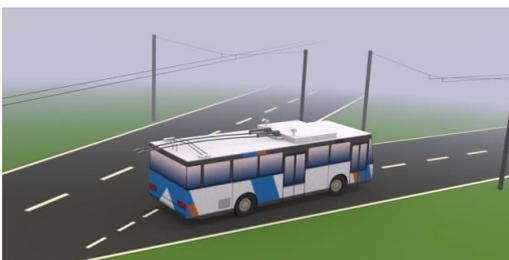
3. Beim Abbiegen fährt der Bus mit autonomer Energie
