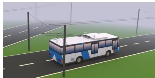
4. Automatisches wiederandrahten nach dem Abbiegen
