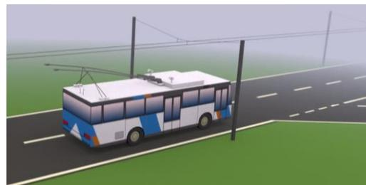
2. Bus wird zum Abbiegen abgedrahtet
